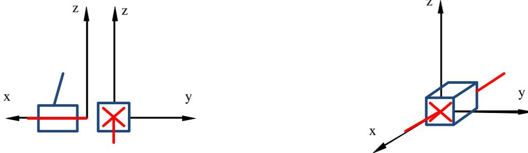
Le degré de liberté en translation peut être obtenu aussi bien par association de surfaces planes que de surfaces de révolution. Selon la nature de ces surfaces assurant la mise en position on distinguera :
